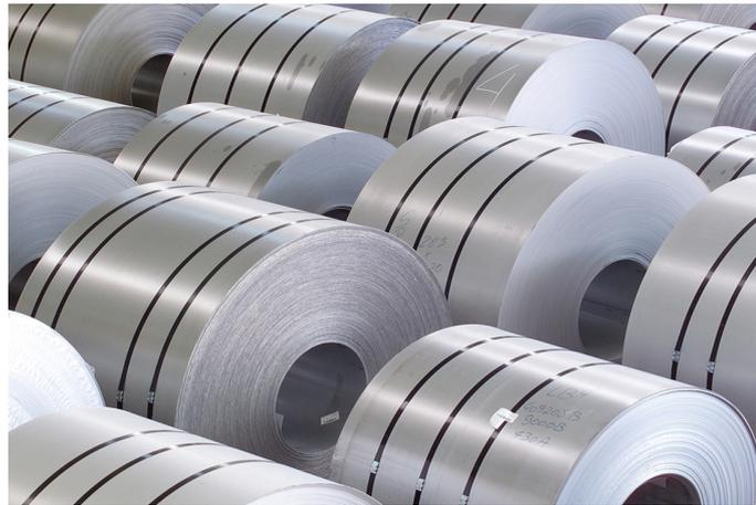
Figura 2.3: Patio de estocagem na entrada do recozimento em caixa.
