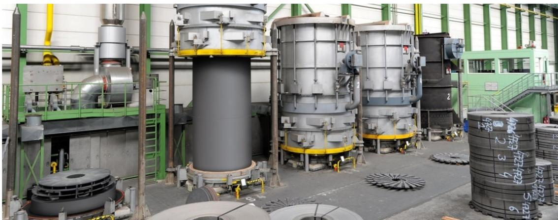
Figura 2.4: Planta típica de Recozimento em Caixa.
