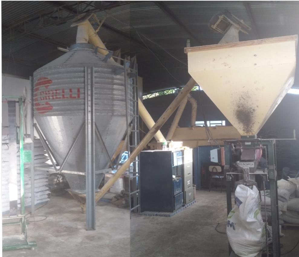
Figura 5.9: Silo de armazenamento e processo de ensaque da ração.
