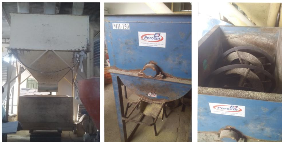
Figura 5.7: Balança e misturador 150 *kg* da fabricação da ração do IFES/ES.
