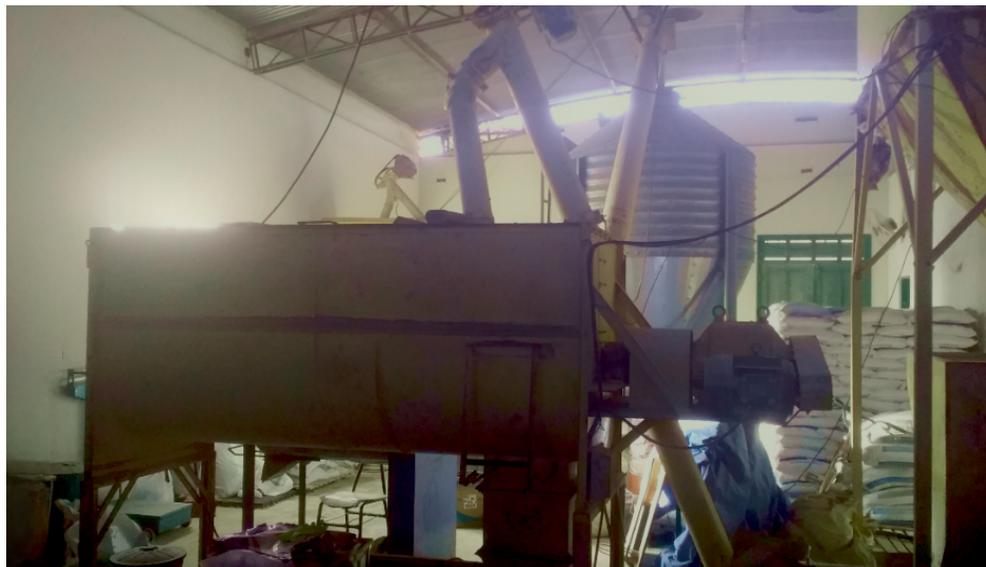
Figura 5.8: Misturador 1 tonelada da fabricação da ração do IFES/ES.
