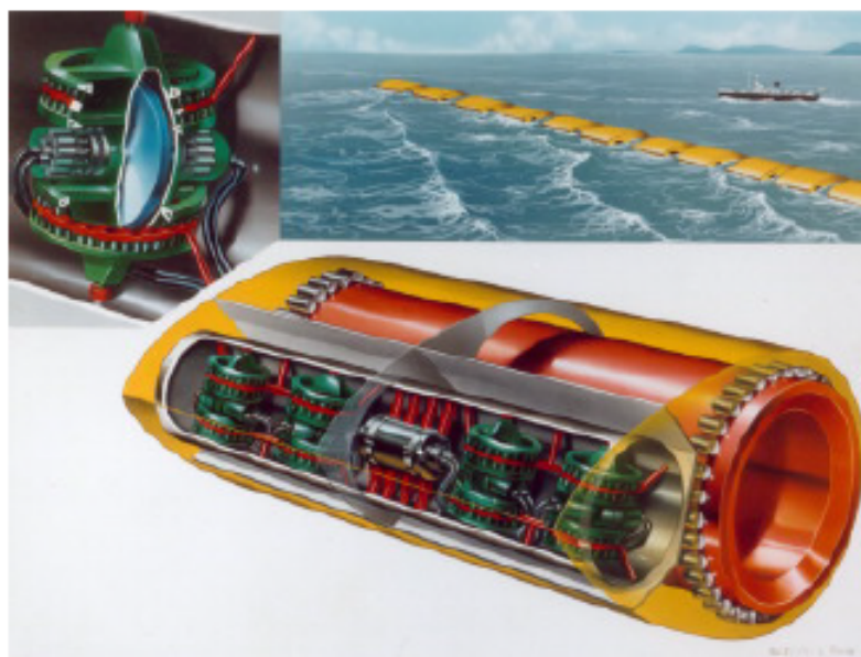
Figura 2.5: Representação esquemática do Salter's Duck adaptado de Antonio (2010).
