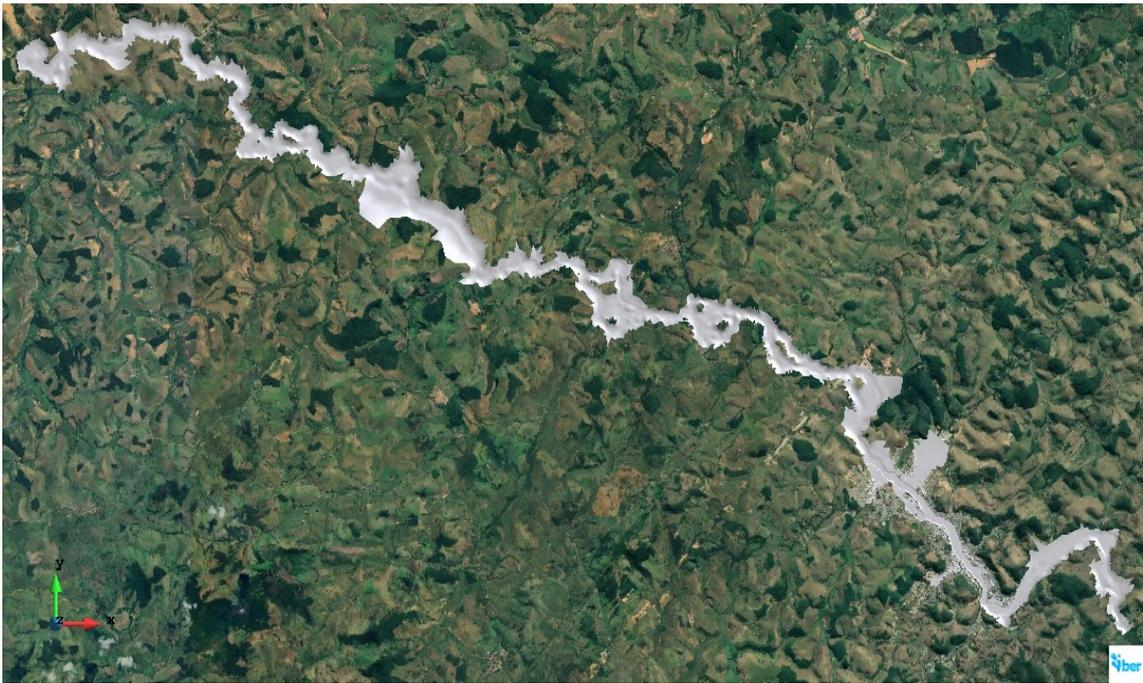
Figura 4.42: Remoção dos elementos secos da simulação referente ao Cenário 5.
