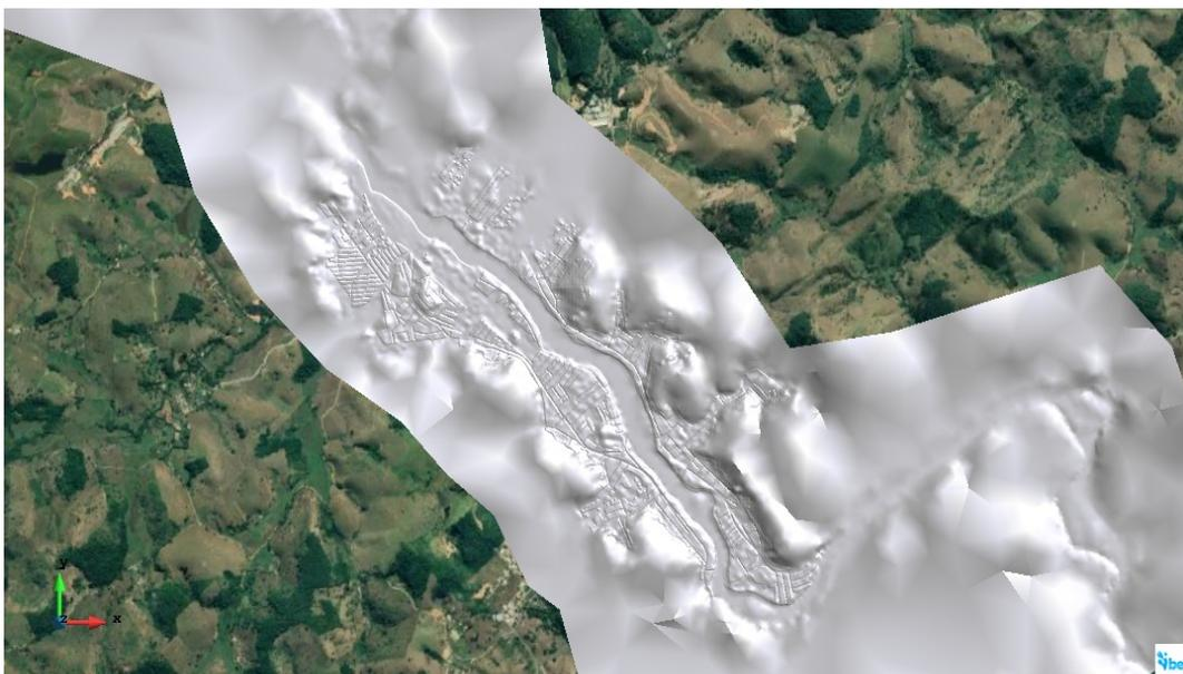
Figura 4.11: MDE Copernicus GLO-30 com rebaixamento no leito do rio em 3 metros e elevação das edificações da área urbanizada em 3 metros.
