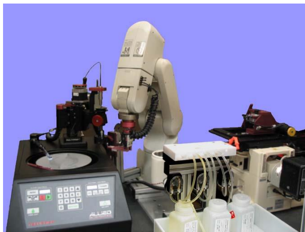
Figura 3.3: Principais componentes do Robo-Met.3D : polidor automático (esquerda), braço do robô (centro), estação de gravação automática (centro inferior) e microscópio invertido motorizado (direita).
