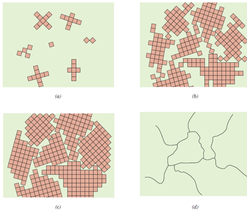
Figura 1.2: Esquema demonstrando as etapas da solidificação de um material policristalino, com a nucleação (a) e crescimento dos cristais (b) até seu encontro e formação dos contornos de grão (c) e (d). [4]
