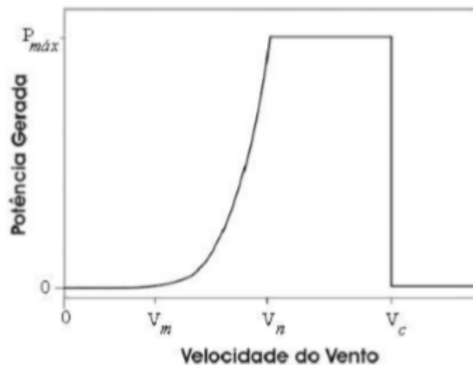
Figura 2.5: Geração de potência de um aerogerador
